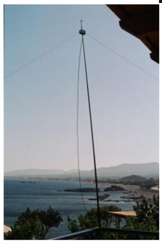
Durante la permanenza, la stazione SV5/IZ4CCO ha operato con una windom ed un dipolo sui 20m. Ho montato il dipolo con balun 1/1 (il tutto home made) sulla solita canna da pesca di 5m sul balcone. Come si vede in foto, il dipolo poteva essere rimosso velocemente. In caso di vento, infatti, volevo essere più tranquillo e quindi smontavo tutta la parte aerea abbassando semplicemente la canna da pesca telescopica.
