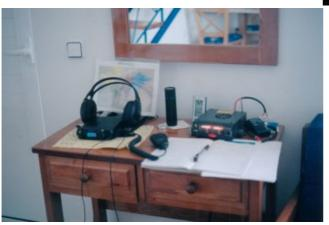
La stazione. FT817, alimentatore, cuffia, microfono, pila, orologio UTC, log e cartina. QRP Max 5W. E' la prima volta che effettuo QSO in QRP abbastanza facilmente. Con una stazione italiana ho addirittura fatto una prova passando ai 2,5W, 1W e 0,5W (ssb+windom). Riuscivo anche con 0,5W a farmi sentire. Certo, il merito era anche delle antenne del corrispondente.
